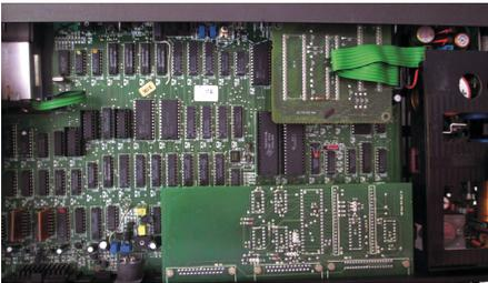
Platine eines Telefunken-Terminals, auf der komplexe Schaltungen mit wenig spezialisierten ICs realisiert sind
