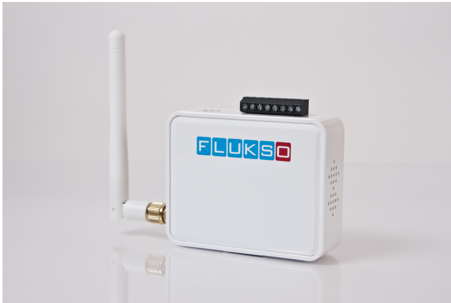
Abbildung 5: Der Flukso ist ein Strommessgerät. An den Schraubklemmen an der Oberseite werden die Sensoren angeschlossen. Für die Kommunikation sind eine WLAN-Schnittstelle und eine Ethernet-Schnittstelle integriert. Quelle: CC-BY-SA-NC Mathias Dalheimer.
