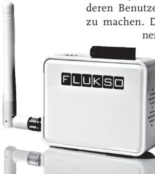
Der Flukso ist ein Strommeßgerät. An den Schraubklemmen an der Oberseite werden die Sensoren angeschlossen. Für die Kommunikation sind eine WLAN-Schnittstelle und eine Ethernet-Schnittstelle integriert. Quelle: CC-BY-SA-NC Mathias Dalheimer.
